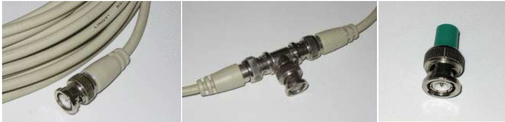
Slika 5. RG-58 kabl sa "ženskim" BNC konektorom, BNC T konektor i terminator
