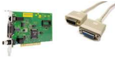
Slika 2. 10BASE5 mrežni adapter i AUI konektor
